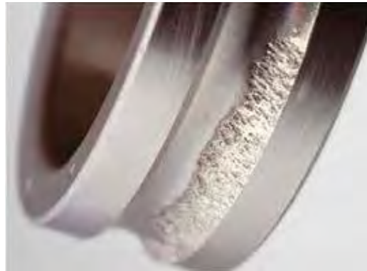
Innenring eines Kugellagers mit geschädigter Lauffläche
