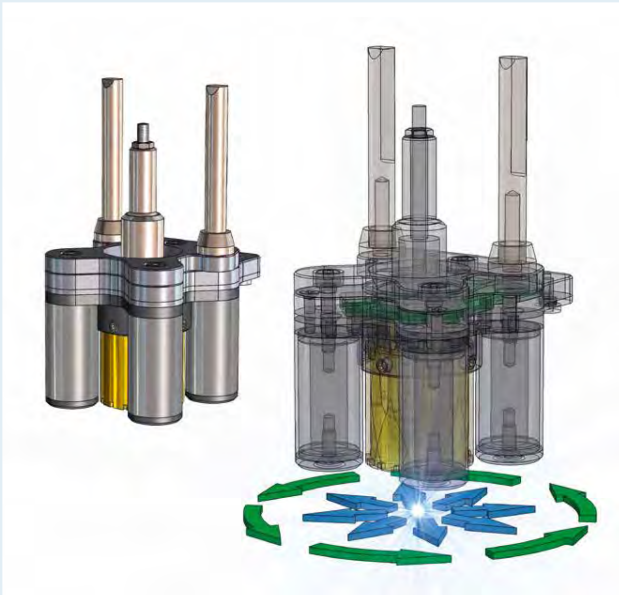
3D-Darstellung der magnetischen Ablenkeinheit mit integriertem Lichtbogen-Positionssensor „SRM® 4.0 – Arc Vision Control System“ Quelle: Andreas Jilg, Heinz Soyer Bolzenschweißtechnik GmbH
