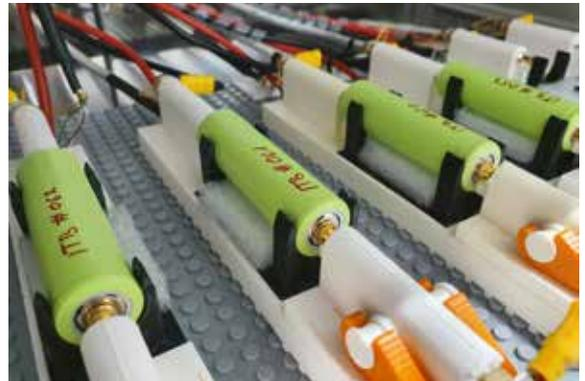
links: Aufbau eines Batteriemoduls der Firma BMZ; rechts: Prüfstand zur Untersuchung des Alterungsverhaltens einzelner Zellen
