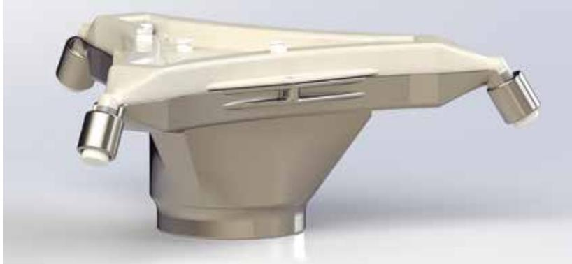
Ein Funktionsmodell, das im Rahmen des Projekts entstanden ist. Die Zellen werden im Inneren des Gefäßes prozessiert und wandern dann nach außen in eines der Auffanggefäße.
