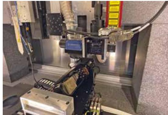
links: Aus Kunststoffpulver gesinterte und anschließend metallisierte Linsenstruktur aus Metamaterial zur Evaluation bei niedrigen Frequenzen; rechts: Fertigungsanlage mit Ablationslaser zur nachträglichen Mikrostrukturierung beliebig geformter Grundstrukturen
