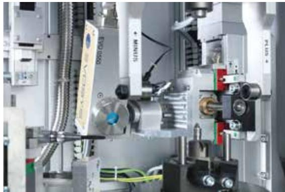
links: Lasergeschweißte Kunststoffampulle mit Düse (nadellose Spritze); rechts: Einblick in eine Maschine für das Laser-Kunststoffschweißen
