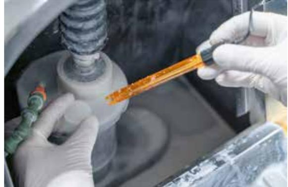
links: Reinigung und Inspektion präzisionsgalvanisierter Bauteile; rechts: Vorbereitung des Polierprozesses und Messung von Prozessparametern beim Polieren optischer Bauteile
