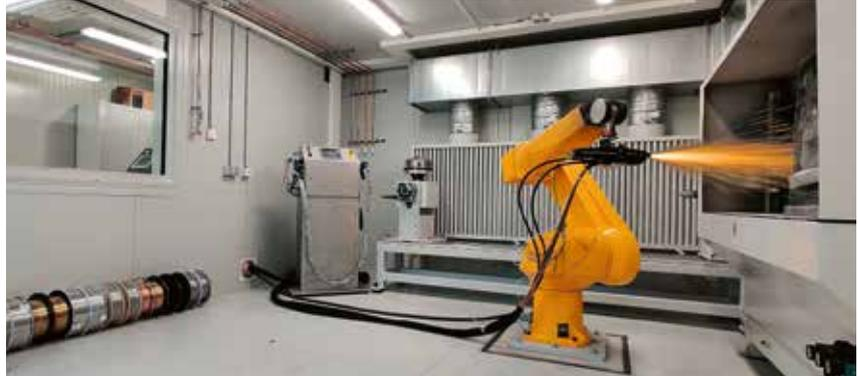
links: Beschichtete Glasform: Es soll eine geeignete Beschichtung entwickelt werden, die eine höhere Abrasions- und Korrosionsbeständigkeit aufweist; rechts: Thermisches Spritzen: Im DemoCenter 3D-thermisches Spritzen werden die Glasformen beschichtet.
