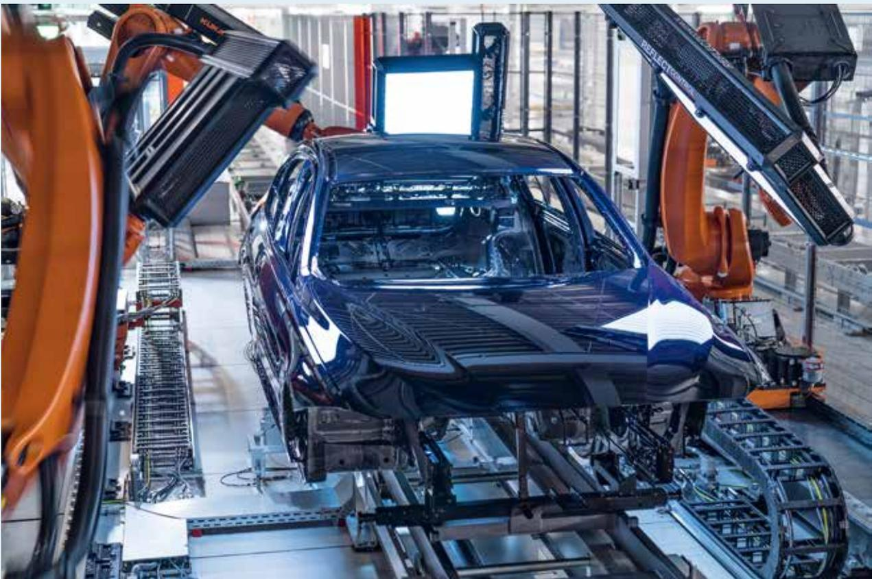
Abbildung 4: Ein Deflektometrie-System prüft die lackierte Oberfläche von Karosserien auf kleinste Oberflächendefekte in der Automobilproduktion.
