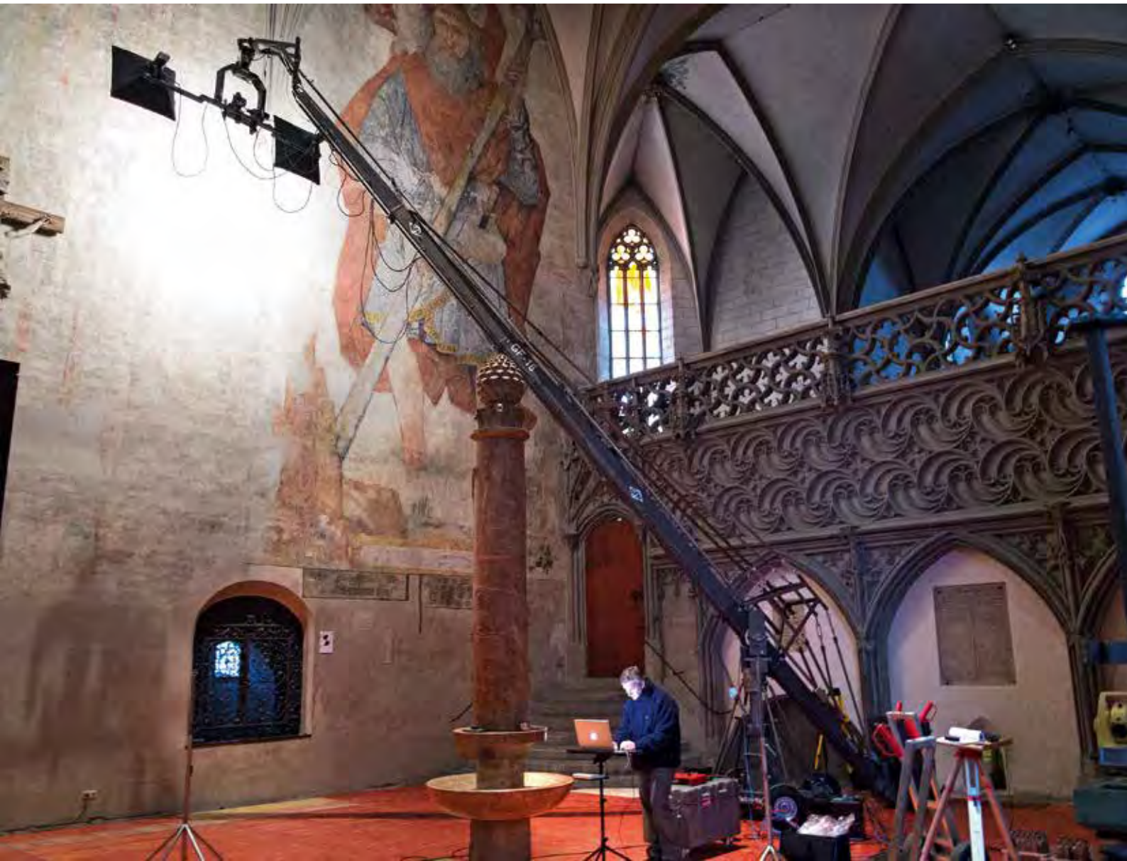
Abbildung 1: Fotoaufnahmen mit dem Kransystem GF-16, Kranarm bis 16 Meter, Augsburger Dom, 2013
