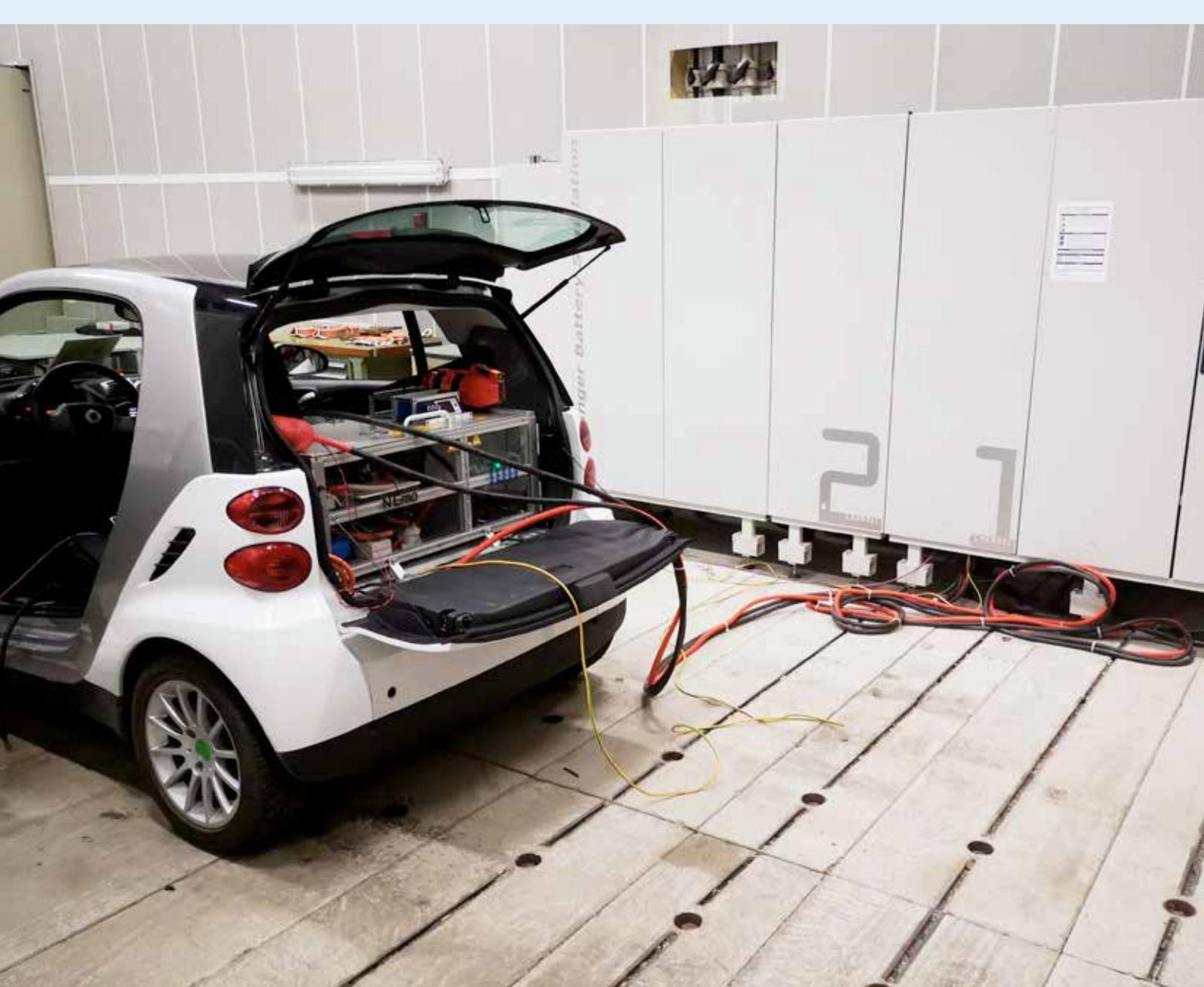
Abbildung 2: Charakterisierung des Batteriespeichers zur Parametrierung des Fahrzeugmodells
