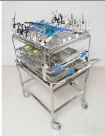
Beladener Korb für ein Reinigungs- und Desinfektionsgerät (RDG); RDG in einer Aufbereitungseinheit für Medizinprodukte eines Krankenhauses
