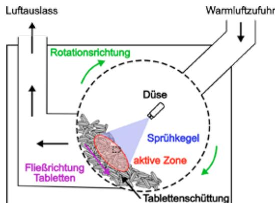
Schema eines Tabletten-Beschichtungsprozesses in einem Trommelcoater
