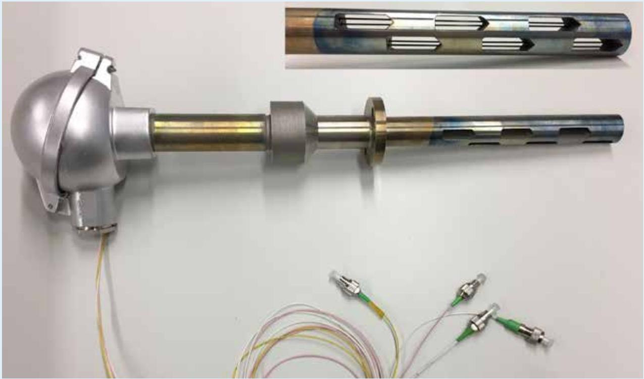
Abbildung 3: Temperaturmesssonde mit vier RFBG-Sensornetzwerken und insgesamt 24 Messstellen nach dem Einsatz im Abgasdiffusor einer Gasturbine. Der Sondenkörper besteht aus Inconel und wurde mittels eines additiven Verfahrens (3D-Druck) hergestellt (Foto: Hochschule für angewandte Wissenschaften München).
