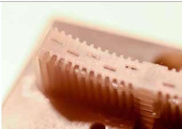
Vergrößerter Ausschnitt einer additiv gefertigten konformen Hohlleiterschlitzantenne entlang gekrümmter Grundform
