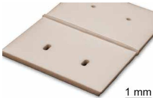
Vibrationsgeschweißte Lasersinter-Verbindung aus Polyamid 12
