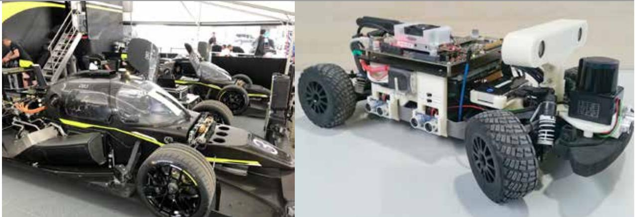
Links: „DevBot“: Einerseits komplett autonom, andererseits bietet es Platz für einen menschlichen Fahrer, der beim Testen der entwickelten Software das Fahrzeug überwachen und im Ernstfall die Fahrzeugsteuerung übernehmen kann; rechts: Das autonome Modellfahrzeug, auf dem die Algorithmen vor dem Einsatz auf dem großen Rennfahrzeug getestet werden können.
