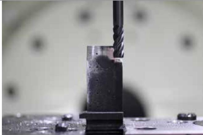
Nachbearbeitung einer additiv gefertigten Turbinenschaufel
