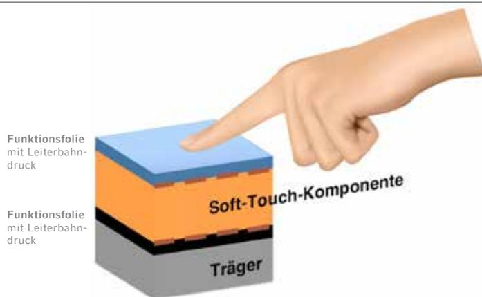
Links: Automobilinterieur der Zukunft; rechts: Aufbau des SenseSkin-Bedienelements
