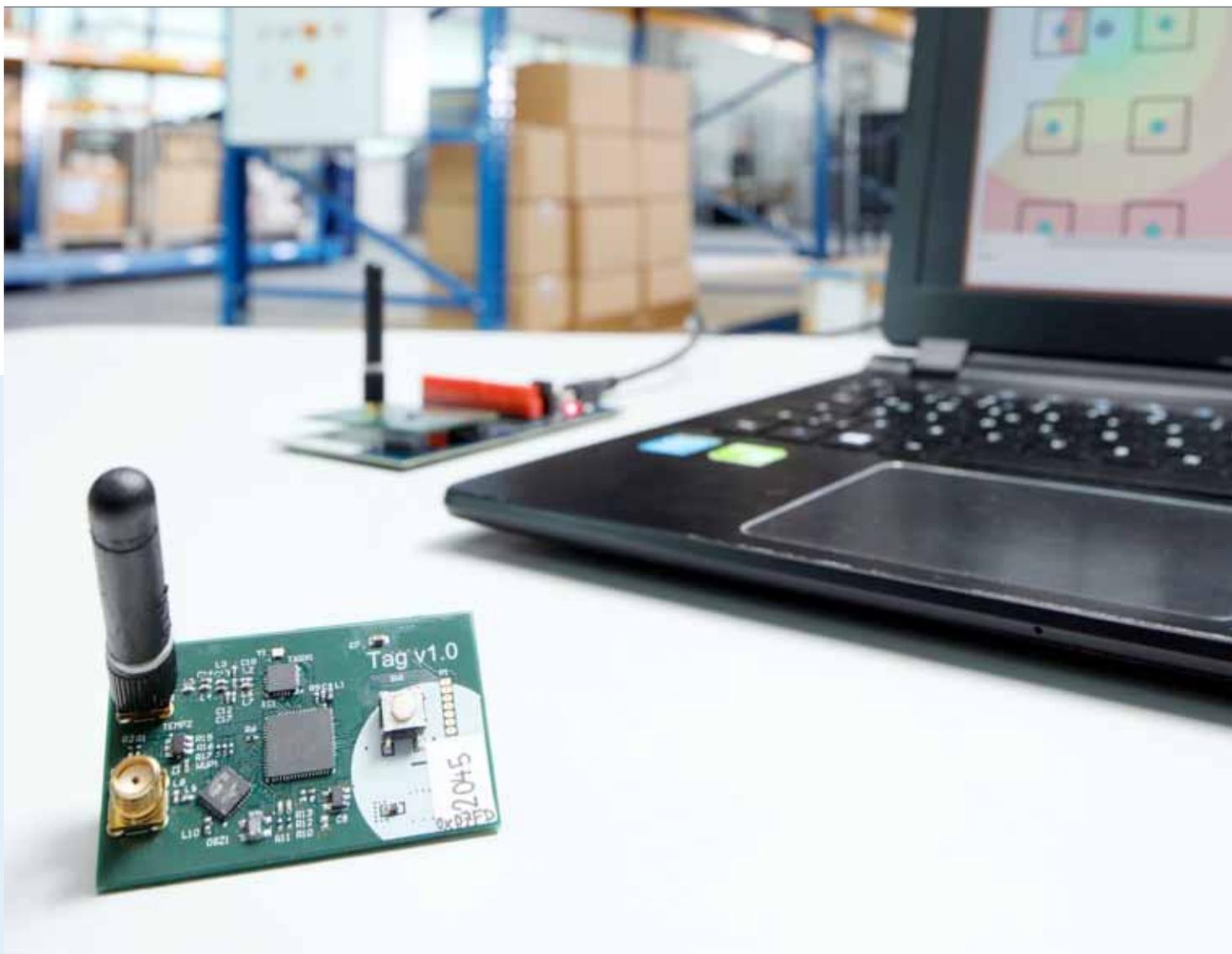
WakeUp-Receiver: Ultra-Low-Power-Lösung zur stromsparenden Lokalisierung ohne hohen Wartungsaufwand und mit einer Betriebsdauer von mehreren Jahren
