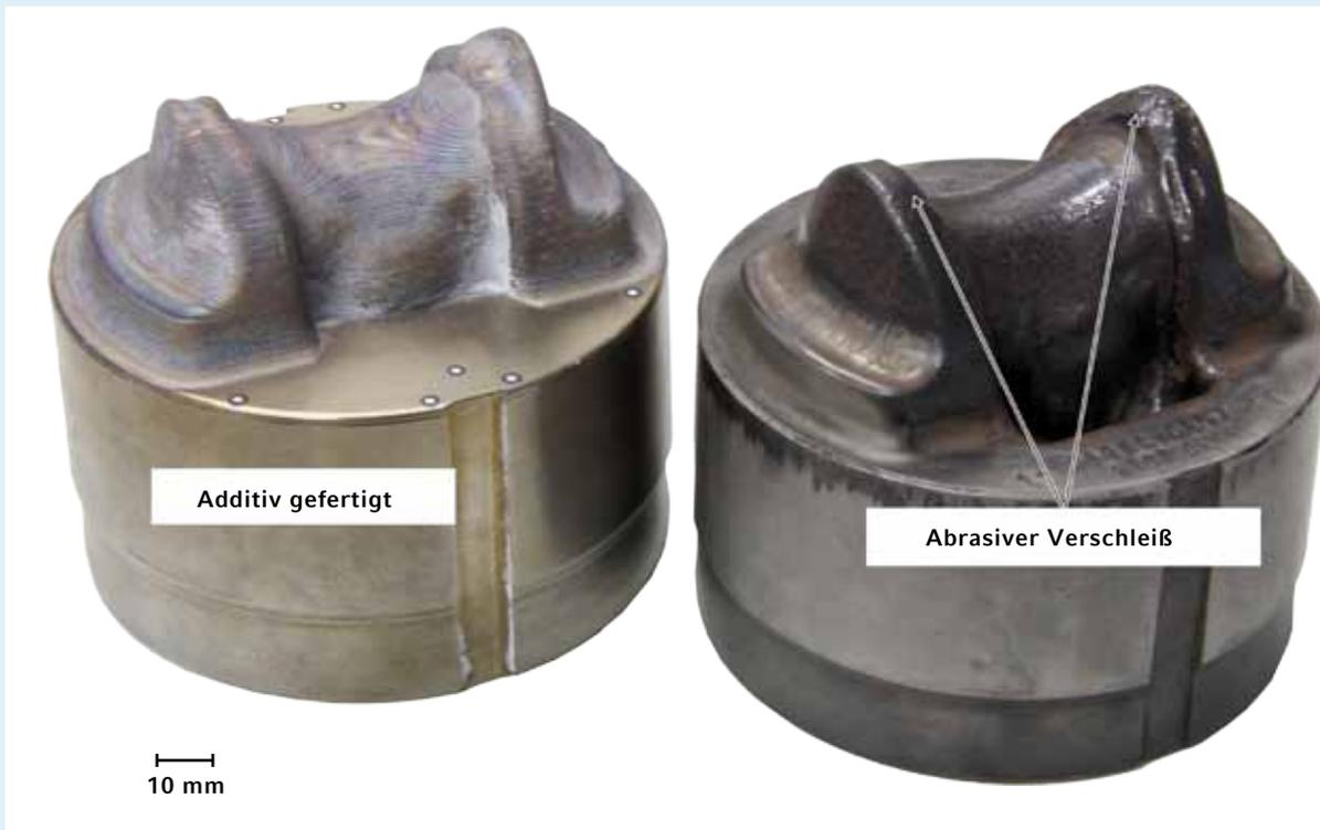
ungen an die Werkzeugqualität von Presshärtewerkzeugen, um die Standzeit der Werkzeuge zu erhöhen und gleichzeitig die Formgebungsgrenzen bei der Warmumformung zu erweitern. Hierfür wurde ein Laserstrahllegierungsverfahren zur gezielten Adaption der chemischen Elementzusammensetzung entwickelt, um lokal die mechanischen Eigenschaften im Hinblick auf eine erhöhte Verschleißbeständigkeit zu verbessern.
