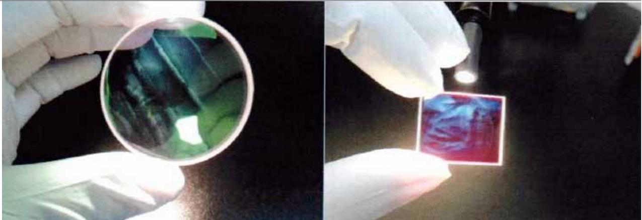
Visuelle Kontrolle beschichteter Glassubstrate mit Schatten und Trübungen an der Grenzfläche Glassubstrat/Beschichtung, sichtbar gemacht mittels Beleuchtung durch eine Kaltlichtquelle
