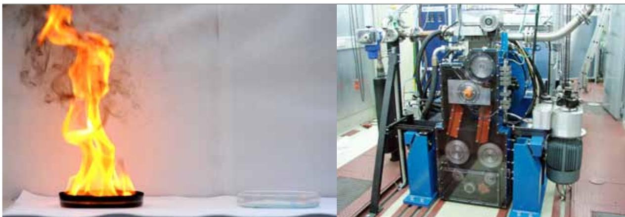
Links: Im Gegensatz zur deutlich rußenden Dieselflamme (links) verbrennt der synthetische Kraftstoff OME (rechts) nahezu rußfrei. (Quelle: Lehrstuhl für Verbrennungskraftmaschinen, TUM); rechts: Einzylinder-Forschungsmotor zur experimentellen Untersuchung des Kraftstoffs. (Quelle: Lehrstuhl für Verbrennungskraftmaschinen, TUM)
