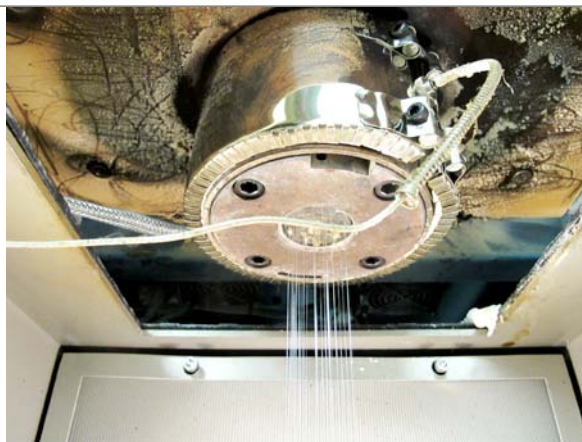
links: Brandtest in einem Cone-Calorimeter; rechts: Spinnndüse zur Herstellung von Polymer-Filamenten
