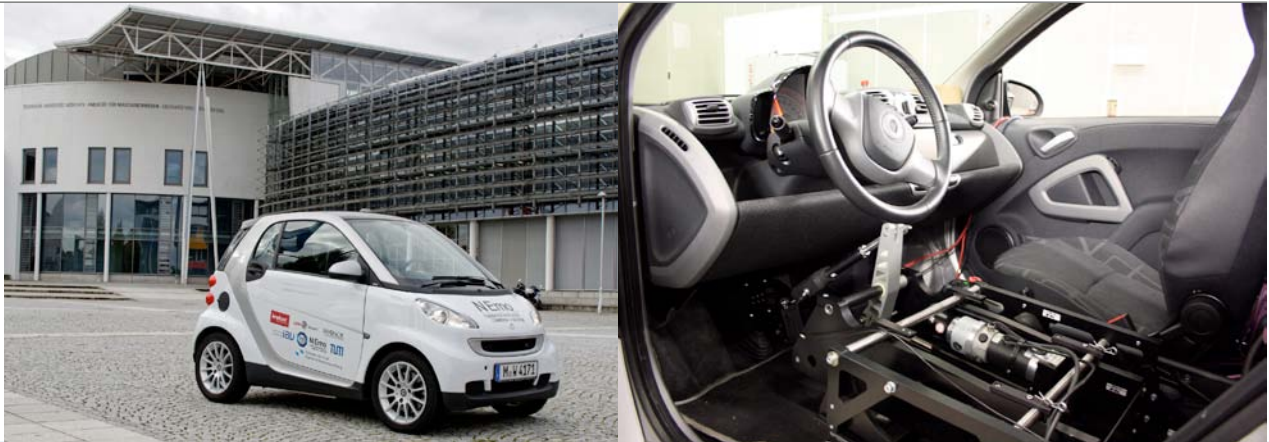
links: E-Smart an der Fakultät für Maschinenwesen der TU München; rechts: Prüfstandversuche mit Bremsaktuator
