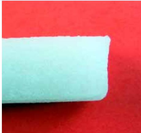
links: Deformation durch eingeschlossenes nichtschwindendes Pulver (Quelle: voxeljet AG), rechts: Verzug und Kantenunschärfe durch zeitlich versetztes Schwinden der einzelnen Schichten (Quelle: voxeljet AG)
