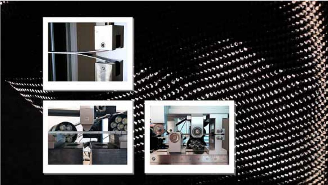
Prüfvorrichtung zur Charakterisierung der CFK/Metall-Grenzfläche auf Couponlevel: Mode-I (DCB) (oben), Mode-II (ENF) (links) und Mixed-Mode-I/II (MMB) (rechts)
