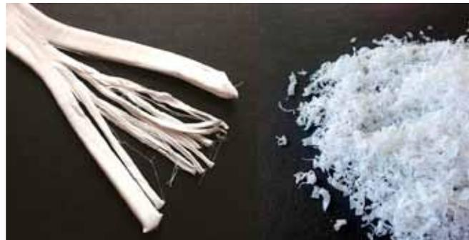
Durch Kondensateinwirkung beschädigte und aufgelöste Mineralfaserfüllung eines Schalldämpfers
