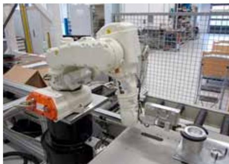
Messaufbau Versuchsreihe I mit den Messsensoren von Mettler Toledo
