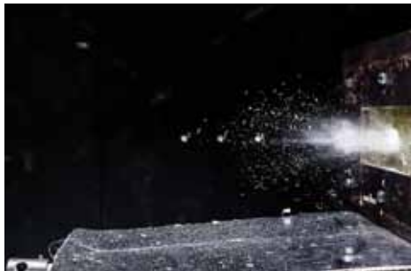
Links: Beschussuntersuchung eines glasfaserverstärkten Kunststoffs [0/90]s mit 520 m/s; rechts: Aufbau der Versuchsdurchführung für High-Velocity-Impact-Untersuchungen
