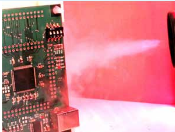
Selektives Dampf-Phasen-Löten auf einer zweidimensionalen Platine
