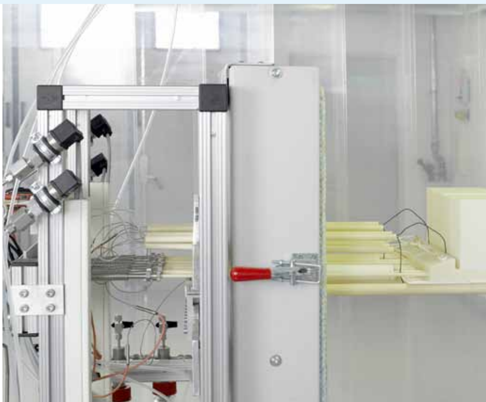
Teststand zur Messung von SOFC-Brennstoffzellen bei der Kerafol GmbH (Bild: Kerafol GmbH, 2015)
