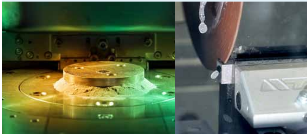
Links: Sinteranlage; rechts: Probenpräparation zur Bestimmung der Restporosität
