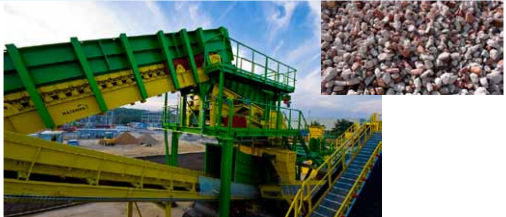
Links: Aufbereitungsanlage für mineralische Ersatzbaustoffe; rechts: Mineralischer Ersatzbaustoff aus aufbereitetem Bauschutt
