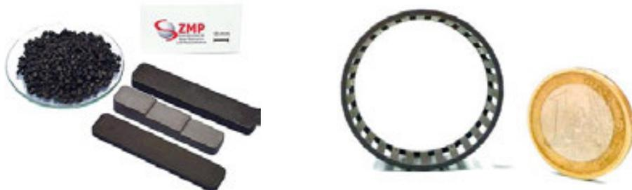
Links: Spritzgießfähiges Granulat auf Agar-Basis und spritzgegossene Probekörper; rechts: Spritzgegossener Nadellagerkäfig aus Mesophasen-Kohlenstoff
