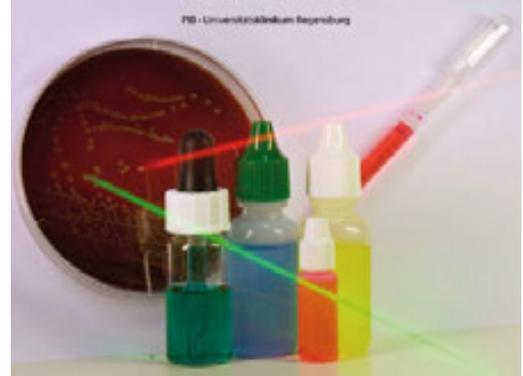
Links: Bestrahlung von Mikroorganismen im Labor; rechts: Spezielle Farbstoffe erzeugen unter Belichtung reaktive Sauerstoffspezies, die unterschiedlichste Mikroorganismen effektiv abtöten
