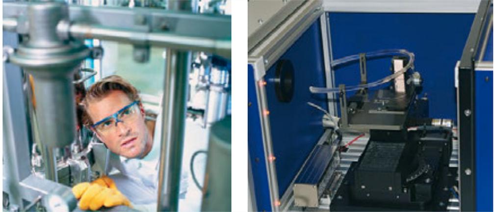
Links: Innovativ und leicht: Arbeitsschutzbrille für Feinmechanik- oder Laborarbeiten; rechts: Optische Prüfung einer Arbeitsschutzbrille am Ende der Prozesskette mit Hilfe der Wellenfrontmesstechnik
