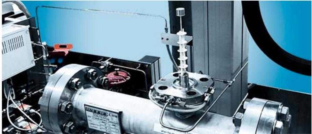
Für den Wechsel der Probe geöffnete Hochdruck-Thermowaage. Zu erkennen sind der Waagendruckbehälter, Teile der Gasversorgung sowie Probenträger und Hitzeschilde aus Aluminiumoxid-Keramik
