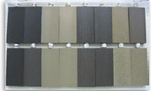
Links: Vergleich des Primärenergiebedarfs und CO<sub>2</sub>-Ausstoßes bei der Hartanodisation (HAA) und der Pulsanodisation (PAA); rechts: Ausgewählte Aluminiumlegierungen, mit Pulsanodisation beschichtet
