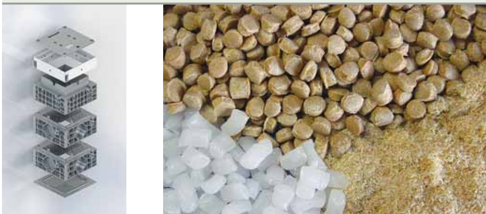
Links: Beispielschacht für die WPC-Umsetzung; rechts: Kunststoff, Holzmehl und WPC-Compound
