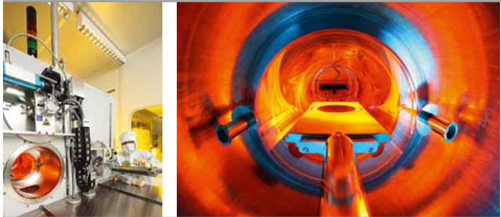
Links: Operator während des Beladens der Epitaxieanlage mit einem SiC-Wafer; rechts: Blick in den Epitaxiereaktor während des Beladens mit einem SiC-Wafer. (Bilder: Fraunhofer IISB / Kurt Fuchs)
