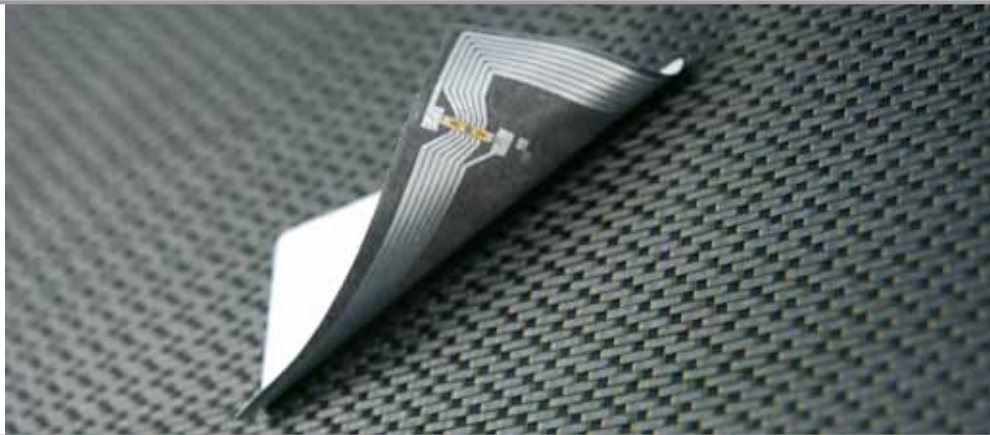
RFID-Transponder (auf Matte aus Kohlefaserverbundwerkstoff)
