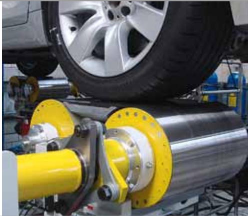
Fahrdynamik-Prüfstand mit gepulster Flachbahn
