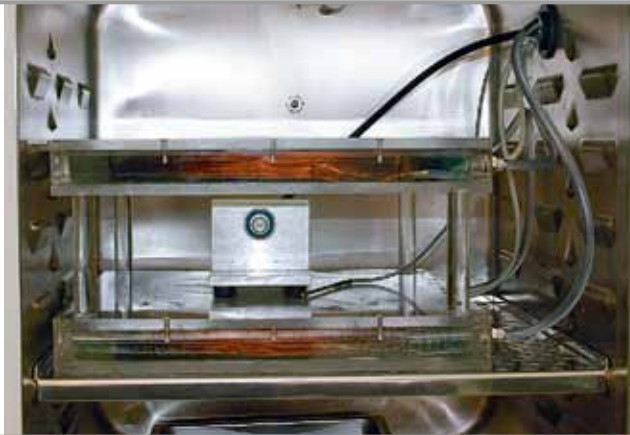
Helmholtz-Spule mit Antrieb für Mikrogravitations-Bioreaktor
