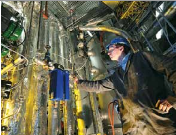
Zusammenführung von rezirkuliertem Rauchgas und Sauerstoff in der Versuchsanlage
