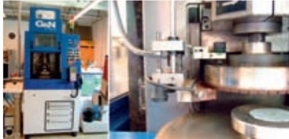
Links: Weißlichtinterferometeraufnahmen ELID-geschliffenes C/C-SiC (oben) und anschließend poliertes C/C-SiC; rechts: ELID-Flachschleifmaschine G&N VTS-3 (links) und Arbeitsraum mit ELID-Elektroden (rechts)
