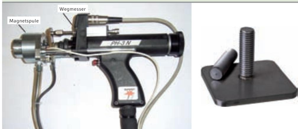
Links: Schweißpistole mit bisherigem Feldformer und Wegmesssystem; rechts: Ansicht M12 Bolzenschweißung im Magnetfeld
