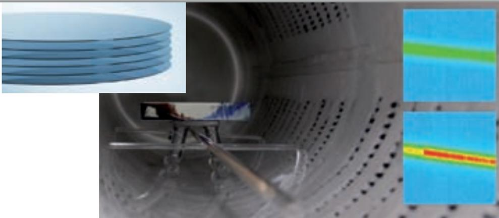
Links: Siliciumwafer mit 300 mm Durchmesser; rechts: Quader aus einem Siliciumeinkristall ( $150 \times 15 \times 20 \text{ mm}^3$ ) auf Quarzhalter im Hochtemperaturofen und röntgenografisches Signal einer Probe ohne Sauerstoffpräzipitate (oben) und mit Sauerstoffnanodefekten (unten)
