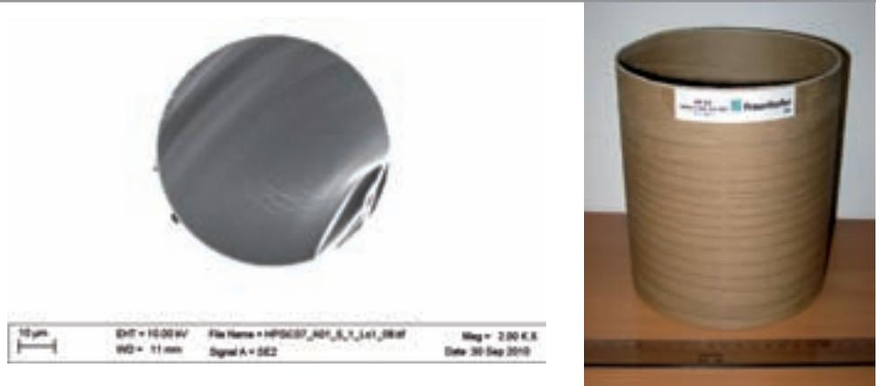
Links: rasterelektronenmikroskopische Aufnahme der Bruchfläche eines SiC-Monofilaments;
