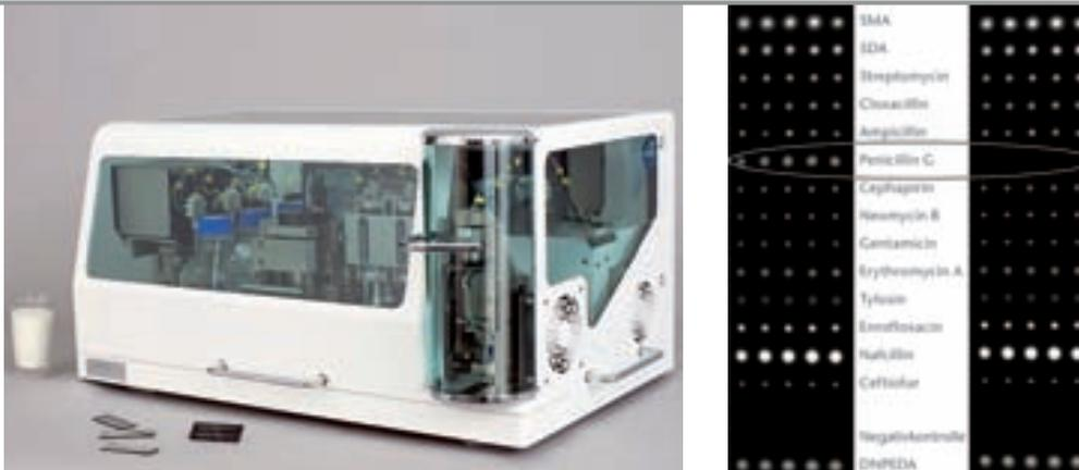
Links: Laborgerät Mikroarray-Chip-Reader (MCR); rechts: Messung der emittierten Chemilumineszenz am Beispiel von zwei Milchproben
