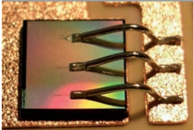
Aufnahme eines gebondeten, monolithisch integrierten RC-Bedämpfnetzwerks
