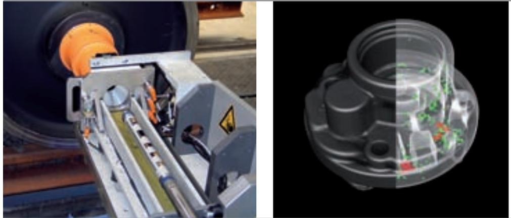
Links: Ultraschallsonde für die Prüfung von Eisenbahn-Hohlwellen. Die Sonde enthält zwei Phased-Array-Prüfköpfe zur Erkennung von Umfangsfehlern und drei konventionelle Prüfköpfe zur Detektion von axialen Fehlern; rechts: Röntgen-Computertomographie erlaubt die zerstörungsfreie Untersuchung von vielerlei Bauteilen. Dargestellt sind die nach Größe farblich kodierten Poren innerhalb eines Gussteiles
