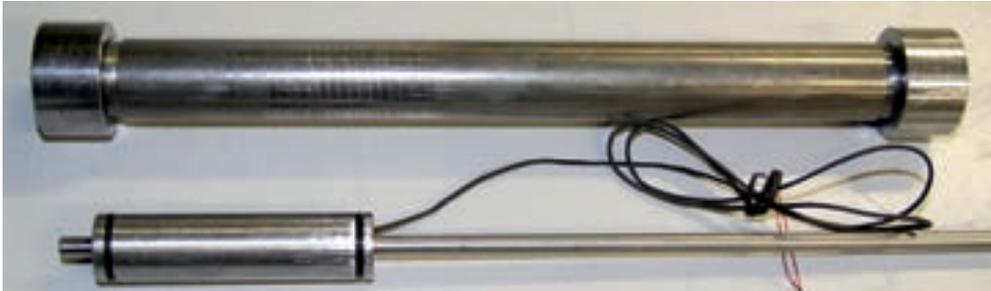
Erster Prototyp des smarten Feststellerelements mit herausgezogenem Kolben
