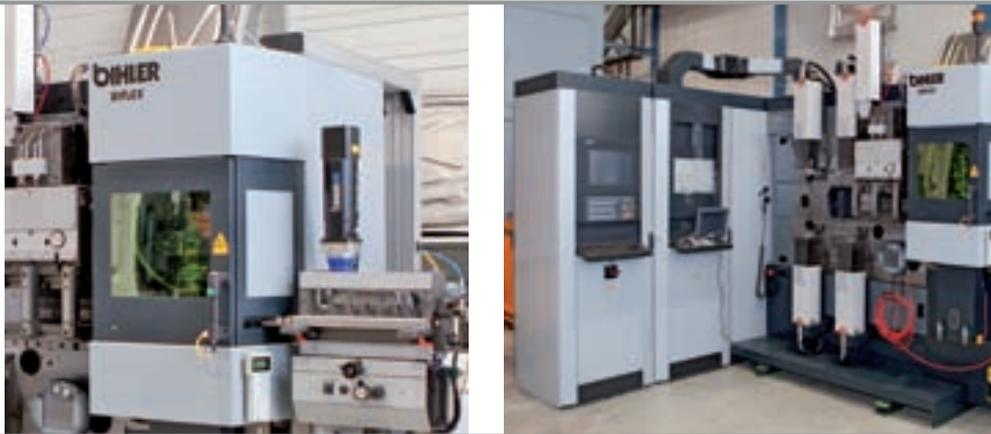
Versuchsdurchführung auf einem hochflexiblen BIHLER NC-Stanz und Biegeautomaten BIMERIC Biflex mit Laserschneidanlage
