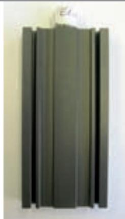
Links: IPA-Versuchsstand zur Hartanodisation im Labormaßstab; rechts: beschichteter 3D-Probekörper für praxisnahe Bedingungen
