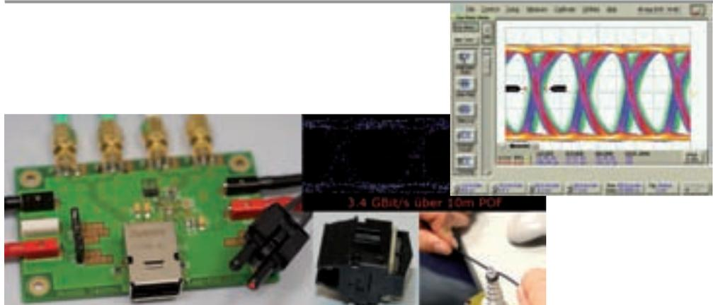
Demonstratorboard mit POF-Stecker, Augendiagramm, Transceiverboard mit Gehäuse, POF-Biegung
