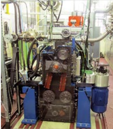
Einzyylinder-Forschungsmotor am LVK
