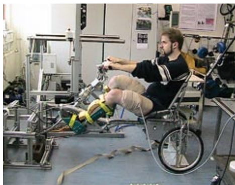
Links: Messaufbau zum Prinzip der rehabilitativen Magnetstimulation; rechts: Abhängigkeit der stimulierten Kraft von der Zyklenzahl der Stimulation bei zwei Probanden
