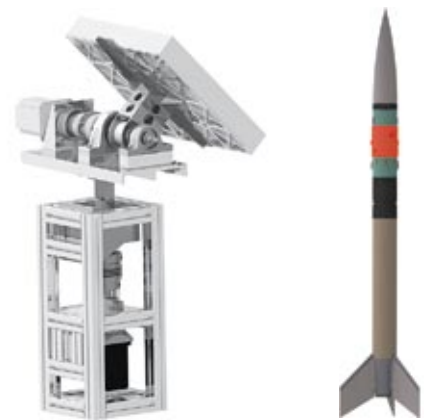
Links: VECTOR-Bodensegment und Antennenmechanismus; rechts: REXUS-Rakete mit dem VECTOR-Experimentmodul
