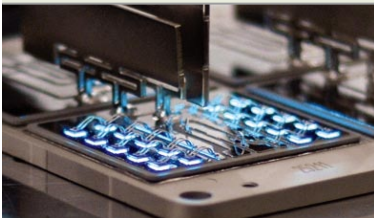
Bipolardioden auf SiC-Basis, die in einem Modulaufbau elektrisch getestet werden. Bildquelle: SiCED
