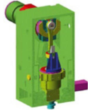
Links: Wälzstoßmaschine (Simulationsmodell); rechts: veränderte Konstruktion nach Simulation: neu entwickelter Stoßkopf
