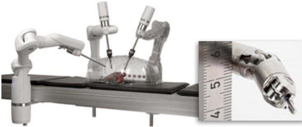
Links: Mirosurge: dreiarmliges Robotersystem für minimalinvasive Eingriffe; rechts: integrierte Kraftsensoren und spezielles Gelenk: Fingerspitzengefühl für den Chirurgen
