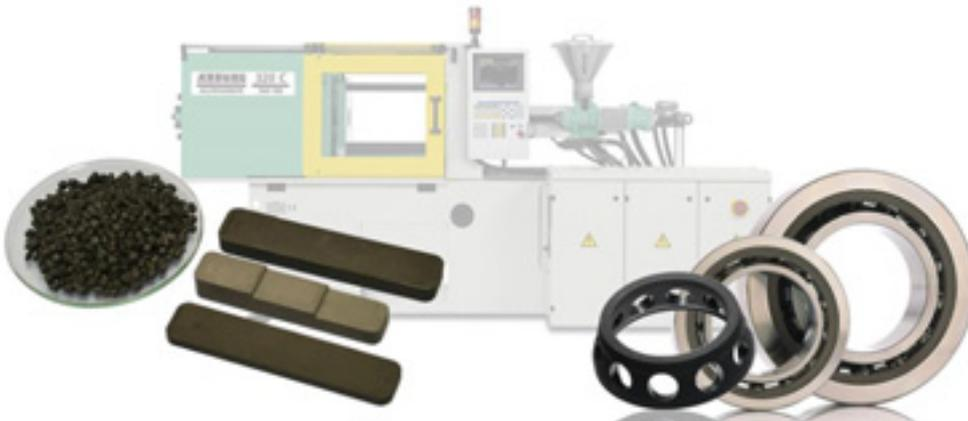
Einsatzmaterial und spritzgegossene Probekörper (li.), Spritzgussanlage (Mi.), Lagerkäfig (re.)
