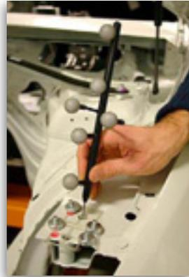
Autokarosserie mit Messtaster: Aufzeichnung der Messpunkte
