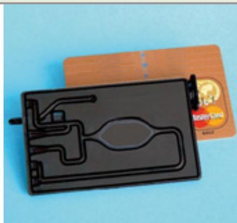
Links: Proben messen, bearbeiten und auswerten: Assayprozessor (li.) und Fluoreszenzreader (re., mit integriertem Rechner); rechts: Herzstück der Analyseplattform: die scheckkartengroße Kartusche
