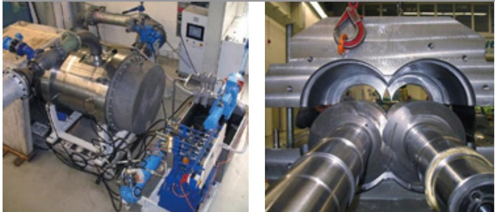
Links: Prototyp der 150-bar-Multiphasenpumpe am Leistritz-Prüfstand; rechts: Fördererlemente der 150-bar-Prototyp-Multiphasenpumpe
