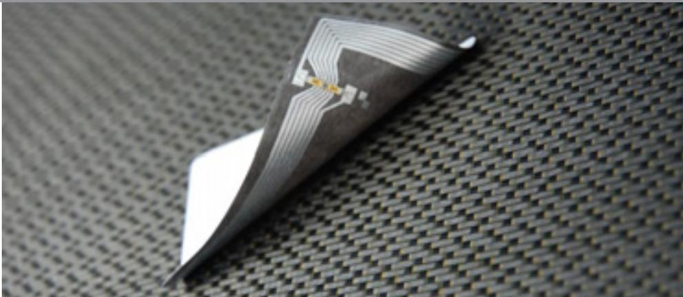
RFID-Transponder (auf Matte aus Kohlefaserverbundwerkstoff)
