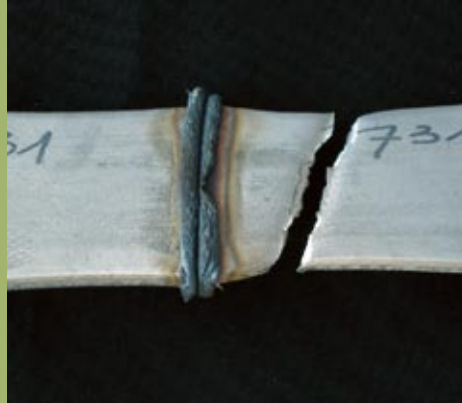
Links: Neue Multiorbitalreibschweißmaschine (Typ MOSYS-100) – Kraft 100 kN, Schwingung 200 Hz, 1,5 mm Rechts: Orbitalreibgeschweißte Verbindung (nach Zugprobe): Verbindung i.O., Bruch im Grundwerkstoff
