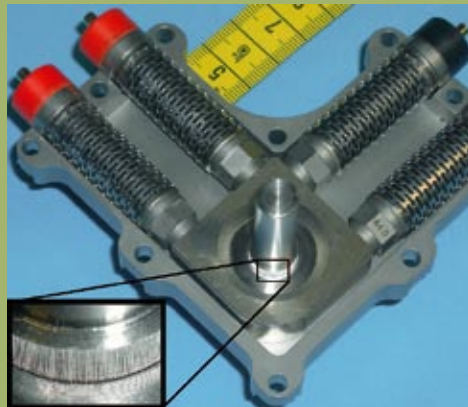
Links: PAD (Piezomotor) – mikroverzahnte Welle und Ring bei offenem Gehäuse Rechts: Zyklidenförmige Mikroverzahnung aus Edelstahl (REM-Aufnahme)
