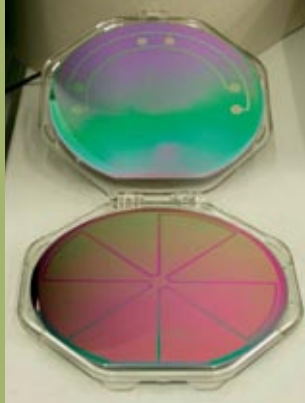
Links: Vorder- und Rückseitenansicht eines rückseitenkontaktierbaren EST-Trägers Rechts: Prozesswafer auf EST-Träger vor dem Prozessieren in einem Hochtemperaturofen
