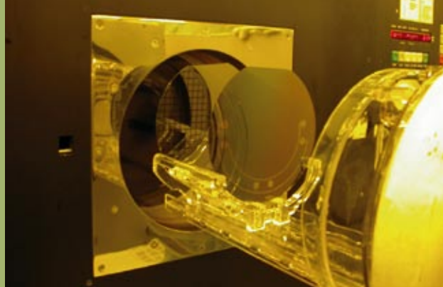
Links: Vorder- und Rückseitenansicht eines rückseitenkontaktierbaren EST-Trägers Rechts: Prozesswafer auf EST-Träger vor dem Prozessieren in einem Hochtemperaturofen
