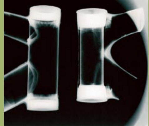
Links: Messrad (Mountainbike) mit Rahmen aus kohlenstofffaserverstärktem Kunststoff Rechts: CFK-Fahrradrahmen – Röntgenuntersuchung
