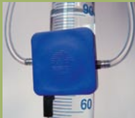
Links: Silizium-Ventile (oben), Prototyp der Hochleistungsmikropumpe (unten) Rechts: Brennstoffzellen im netzfernen Einsatz
