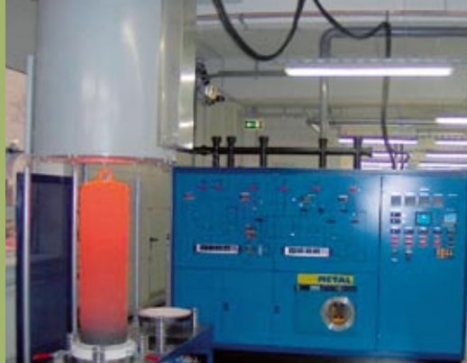
Links: Gasphasenabscheidungs-Anlage für neuartige Zwischenschichtsysteme mit rotglühendem Reaktor Rechts: Stahl Spritzguss-Insert (erster Prototyp) – homogene, haftfeste Diamantbeschichtung auf neuentwickelter Zwischenschicht
