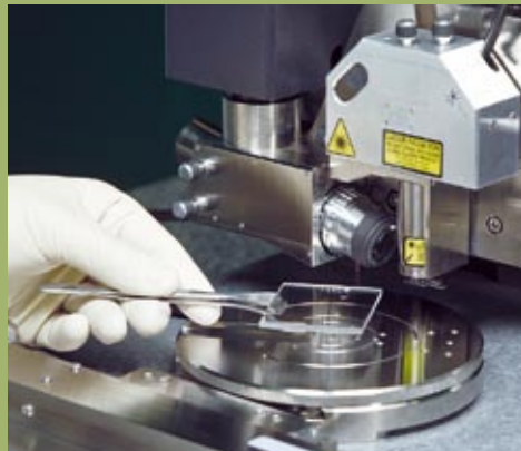
Links: Analyse von Schichtstrukturen (hoch auflösende Rasterkraftmikroskopie) Rechts: Topographie – poröse Sol-Gel-Schicht (rasterkraftmikroskopische Aufnahme)
