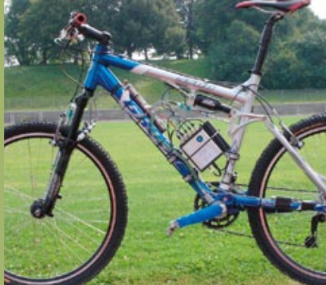
Links: Messrad (Mountainbike) mit Rahmen aus kohlenstofffaserverstärktem Kunststoff Rechts: CFK-Fahrradrahmen – Röntgenuntersuchung
