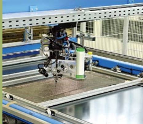
Links: NC-Portalnähanlage – Vernähen der Kohlefaserlagen Rechts: Injiziert und bearbeitet: Musterbauteil
