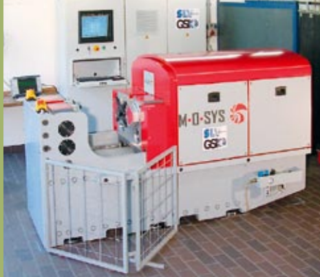
Links: Neue Multiorbitalreibschweißmaschine (Typ MOSYS-100) – Kraft 100 kN, Schwingung 200 Hz, 1,5 mm Rechts: Orbitalreibgeschweißte Verbindung (nach Zugprobe): Verbindung i.O., Bruch im Grundwerkstoff
