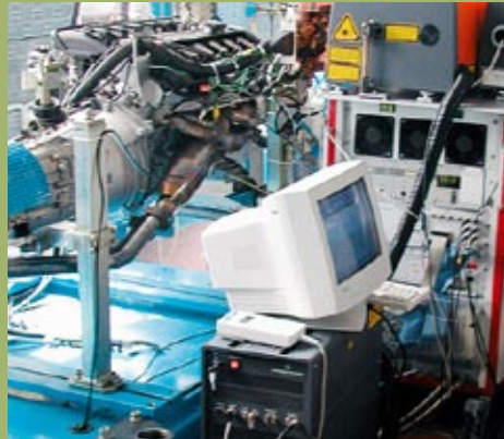
Links: Gerät für Spurenanalytik von Emissionen aus Verbrennungsmotoren (Schema) Rechts: Laboraufbau – Lasermassenspektrometer an einem Motorenprüfstand
