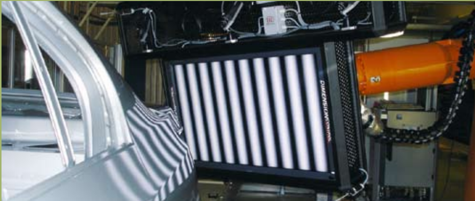
BMW-Werk Dingolfing: Messsystem in der Karosserie-Oberflächenkontrolle
