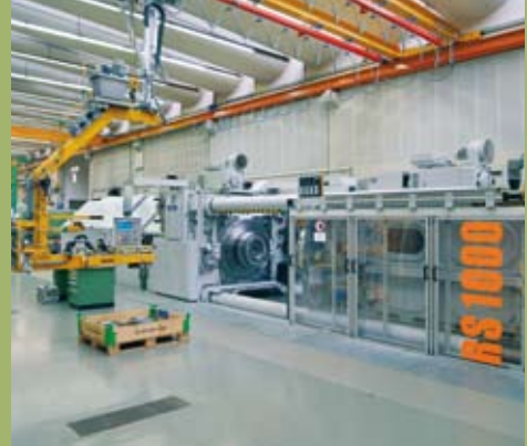
Links: Verdichterrotor in Blisk-Bauweise (Blisk = Bladed Disk). Rechts: Innovatives Doppelspindelkonzept – Funktionsmuster der Reibschweißmaschine.
