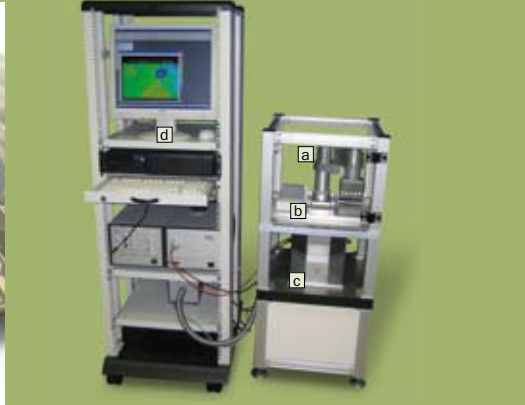
Links: Multiwellplatte – Boden mit integrierten Sensoren. Rechts: Screeningsystem (Muster) mit Systemkomponenten: a) Pipettierroboter, b) sensorbestückte Multiwellplatte, c) Lichtmikroskop, d) Steuerungs-PC
