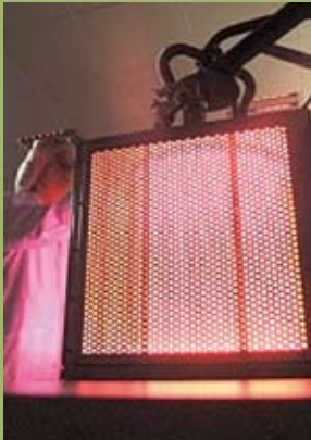
Links: Nanotechnologischer Plasmabeschichtungsprozess. Rechts: Weichmacherfreisetzung von unbeschichtetem und titanisiertem PVC im Blut bei 48 Stunden Versuchsdauer
