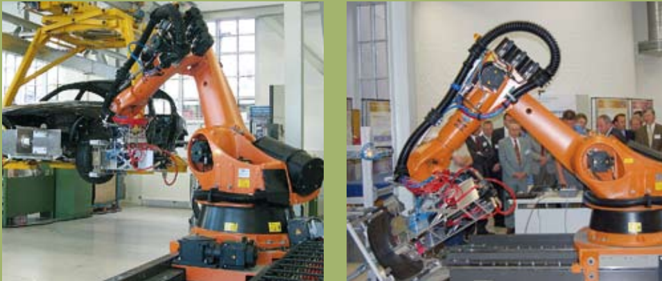
Links: Neuartiges Robotersystem für die förderbandsynchrone Montage. Rechts: Versuchsstand mit Besuchern des MiB(Montage in Bewegung)-Projektabschlusses am 25.09.2007
