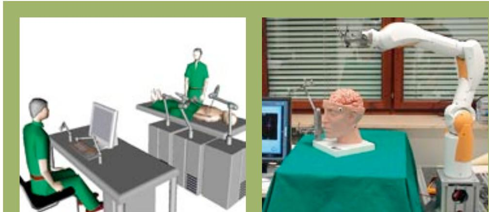
Links: Prinzipieller Aufbau des Telepräsenzsystems für die minimal invasive robotergestützte Chirurgie
