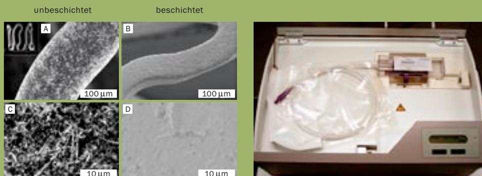
Links: Oberflächenstruktur der mikroporösen, unbeschichteten (A+C) und medikamentös beschichteten Stentoberfläche (B+D). Rechts: ISAR Stentbeschichtungsmaschine mit eingelegter Stentkartusche. Die Stentbeschichtung kann direkt im Katheterlabor erfolgen.
