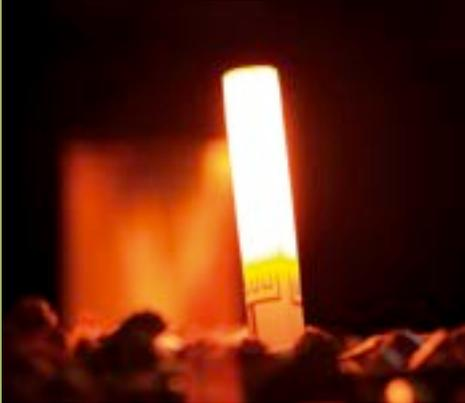
Heizelement im Glühzustand bei 1200 °C
