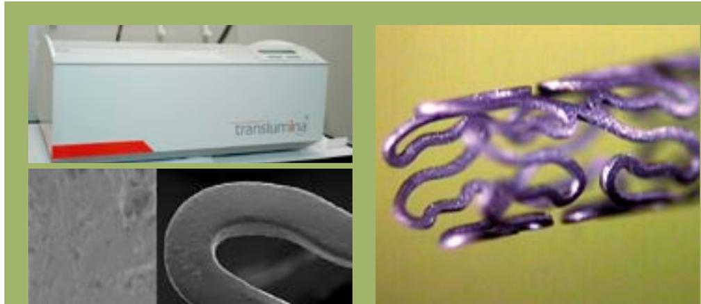
Links oben: Apparatur zur Stentbeschichtung. Links unten: REM-Bild eines Koronarstents mit Medikamentenbeschichtung. Rechts: Beispiel für Stent-Design.
