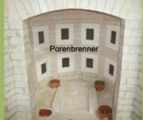
Links: Porenbrenner in Betrieb. Rechts: Innenansicht des Hafenoßens mit Porenbrennern.
