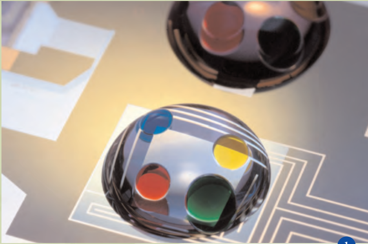
Abb. 1: Ein virtuelles Reagenzglas auf einem programmierbaren Biochip. Die farbigen Tröpfchen sind unterschiedliche DNA Proben, die von einer Ölschicht umgeben sind, um die Verdunstung zu vermeiden.
