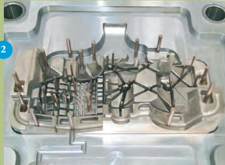
Abb. 2: Rapid Technologien im Werkzeugbau (Indirektes Metall-Lasersintern)
