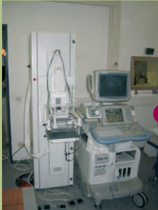
Abb. 1: Abbildungssystem für die Ultraschall-Mammographie.
