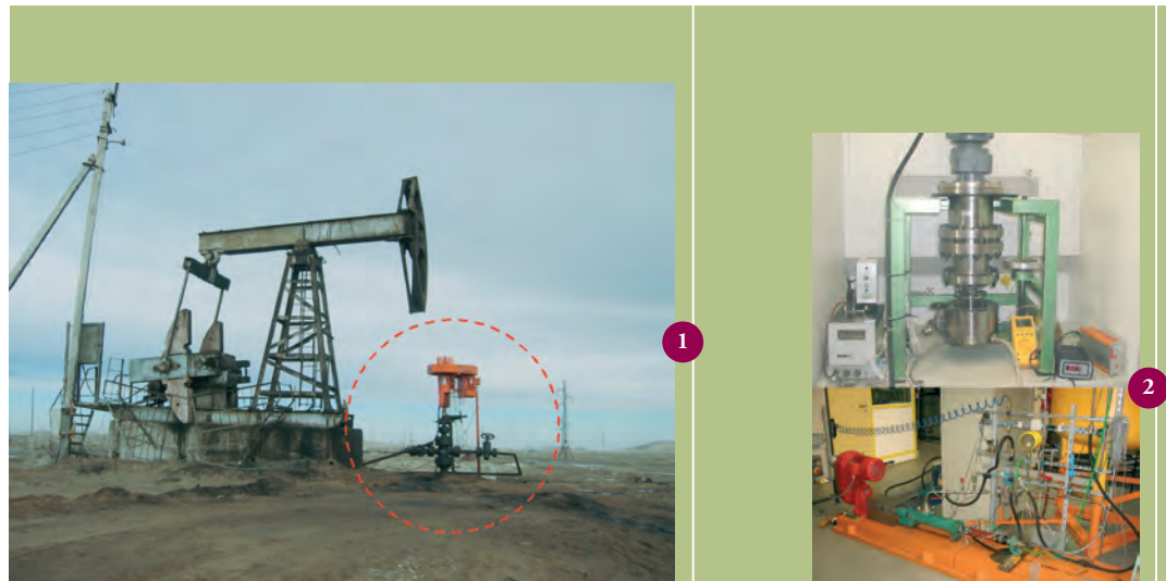
Abb. 1: Exzentrerschneckenpumpe vs. Pferdekopfpumpe. Abb. 2: Tribometer & Pumpenprüfstand.
