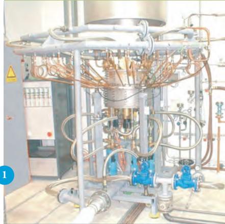
Abb. 1: Versuchs-Ringbrennkammer einer Gasturbine für thermoakustische Messungen.
