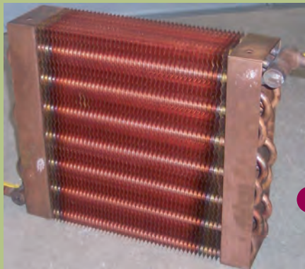
Abb. 1: Testmuster eines kompakten Lamellen-Wärmetauschers.
