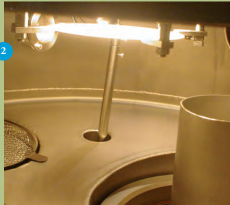
Abb. 2: Prozesskammer für photonenaktivierte Reinigung und Abscheidung.
