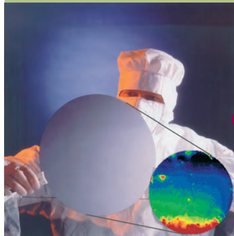
Abb. 1: 300 mm Siliciumscheibe und Abbild von Fehlstellen im Isolator Abb. 2: ELYMOS-Messkammer
