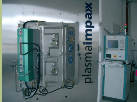
Abb. 1: Rekonstruktion eines aufgrund einer Tumorerkrankung defekten Kiefergelenks mittels Endoprothese. Abb. 2: Plasmaimpax-System zur DLC-Beschichtung von Bauteilen und Implantaten.
