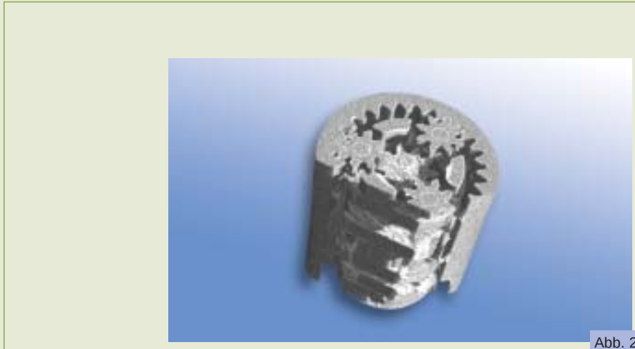
Abb. 2 Volumen-Computertomographie am Kunststoffgetriebe des weltweit kleinsten Antriebs (Fa. Faulhaber)
